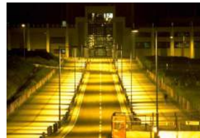
上方への光をなくしたポール灯で路面を的確に照らしている事例
