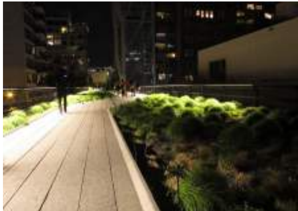
景観を妨げない手摺間接照明で緑を感じる事例
