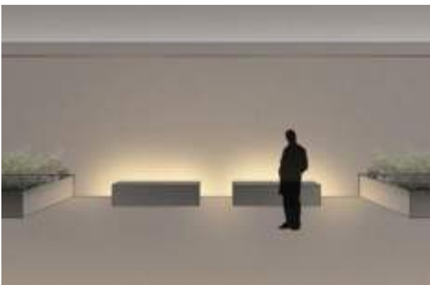
ベンチを利用した壁面間接照明
