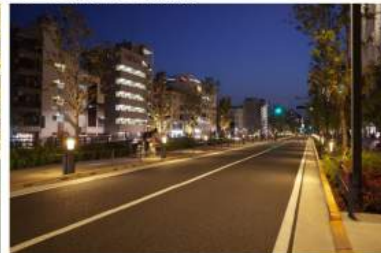
低位置の車道照明で周辺の光環境と一体になっている事例
