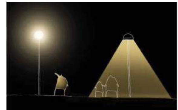
グレアのひどいシチュエーション(左) 照度が管理されたシチュエーション(右)
